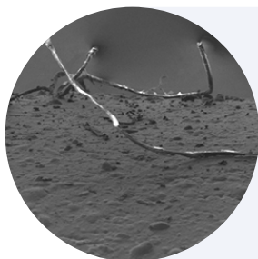
Filamentos de cinc (zinc whisker): Imagen de filamentos de cinc tomada por microscopio electrónico de barrido (SEM) sobre la superficie de un alambre de acero con recubrimiento EZ
