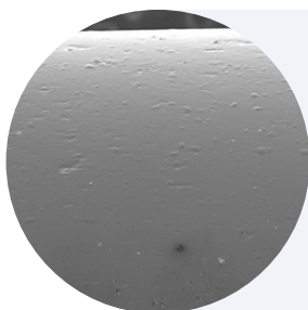
Imagen tomada por microscopio electrónico de barrido (SEM) de la superficie de un alambre de acero con recubrimiento EZ, sin filamentos de cinc
